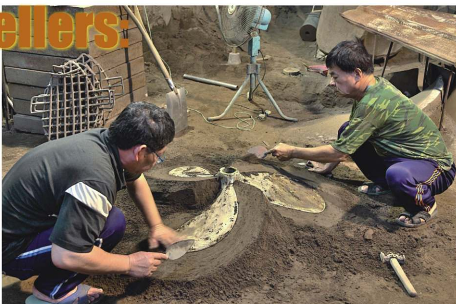
手製船用螺旋槳講求許多技術
