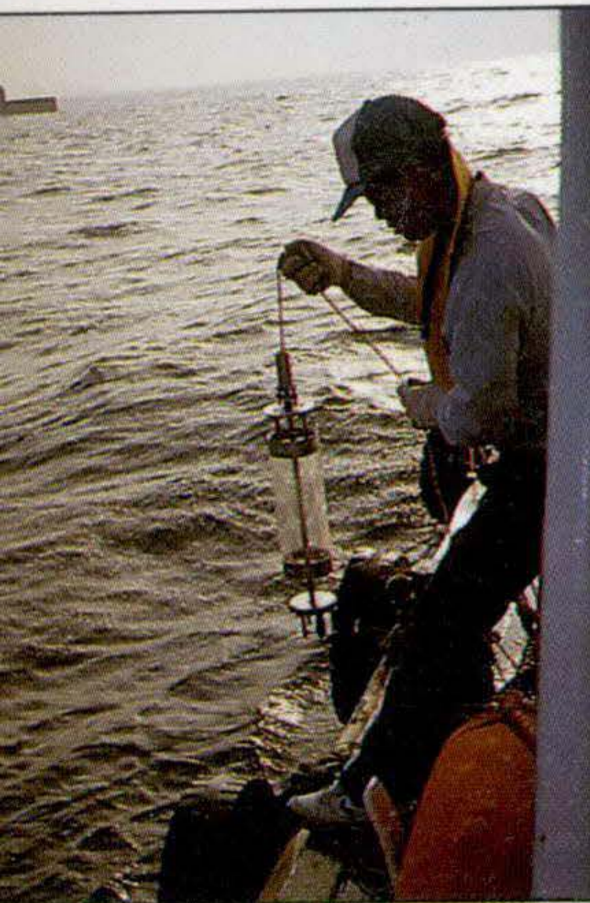
操縱長罐型取水設備須熟練技巧
