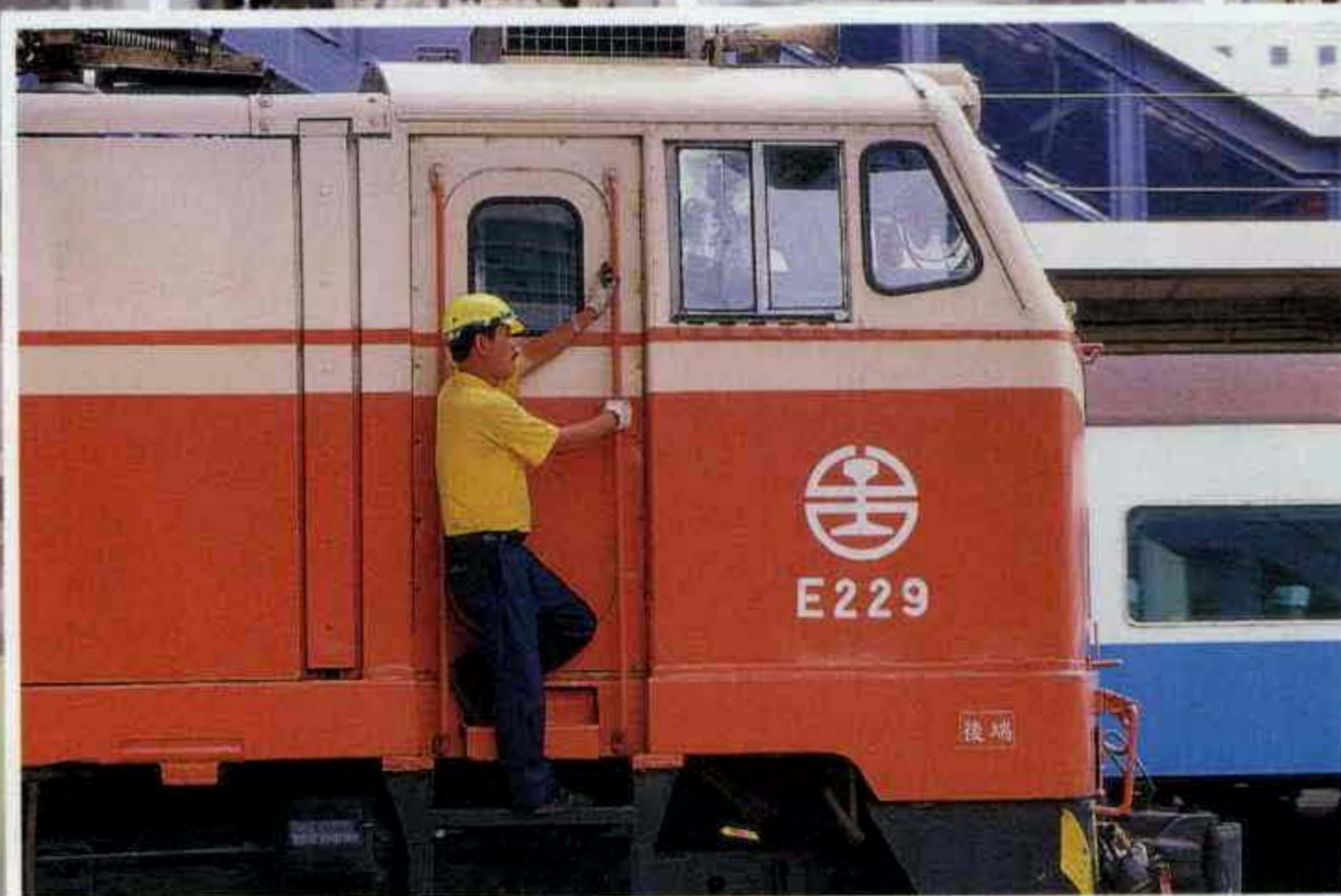
當火車抵達終點站高雄時，即分離機關車與客乘列車，機關車則由大轉盤駛往機務段整備，客乘列車則由柴電調車機推往檢車段檢查清洗。(攝影 / 謝明祚)
